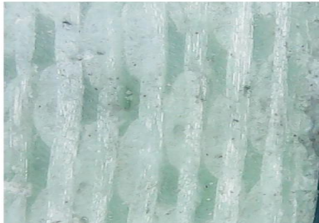
Fig 5 : 管の断面写真 y 周方向 z 軸方向
